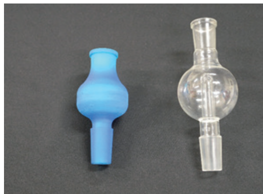
3Dプリンタ製作物(左：改良品 右：既製品)
