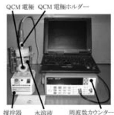
図3. QCM計測システム
