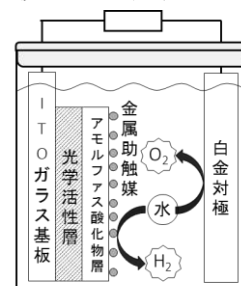
光カソード電極 Fig. 1 デバイス構造
